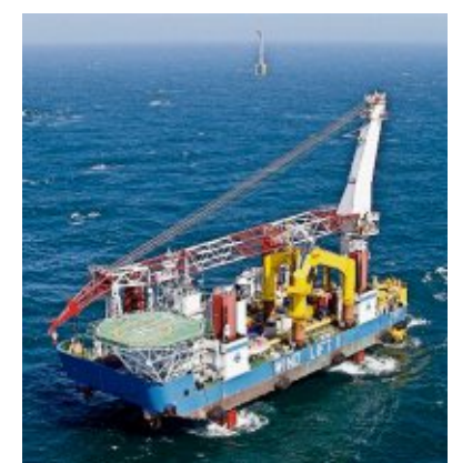
Die Hubplattform „Wind Lift I“ kommt beim Bau und der Reparatur von Offshore-Windrädern zum Einsatz. Foto GustoMSC
